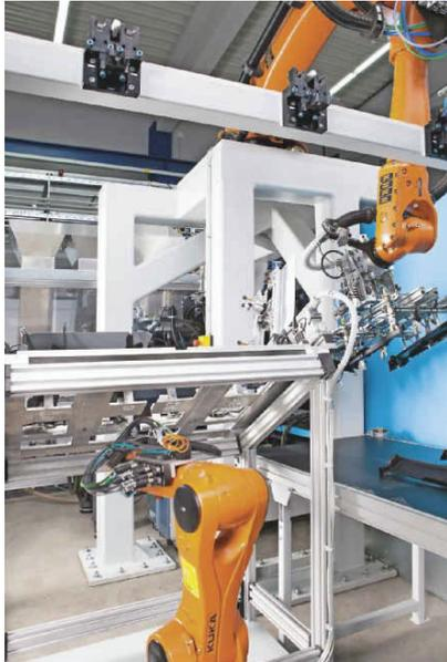
Die Arbeitsteilung der Kuka-Roboter in der kompakten Spritzgießzelle: Der Konsolroboter KR60 handhabt von oben die großen, spritzgeossenen Motorraum-Abdeckungen (hier nicht zu sehen), während der kleine, flinke Sechssachser KR10 von unten die Prüfungen mit Kamera vornimmt und mit Greiferzange die Clips montiert. Bild: Kuka
